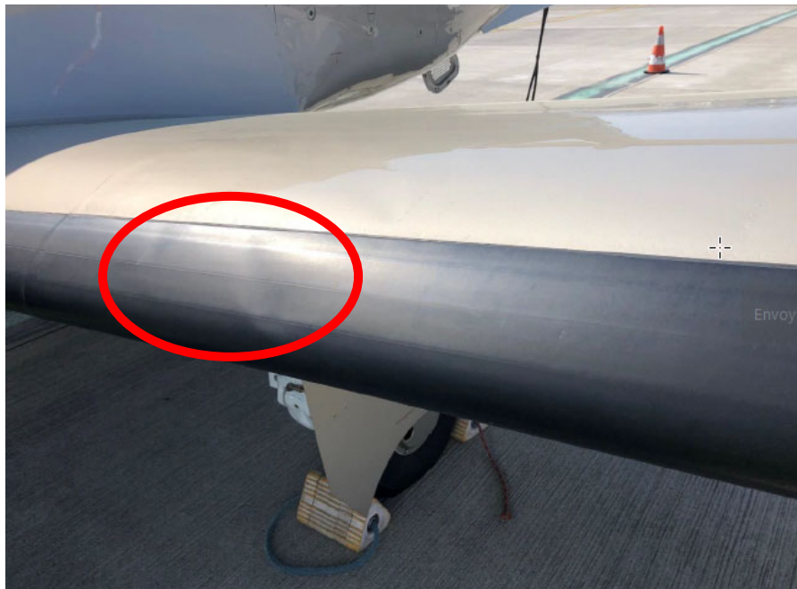
Figure 5 : Déformations observées sur le bord d'attaque de l'aile gauche
