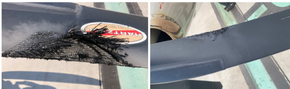
Figure 2 : Dommages observés sur une pale d'hélice
