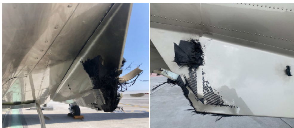
Figure 3 : Dommages observés sur la quille latérale droite
