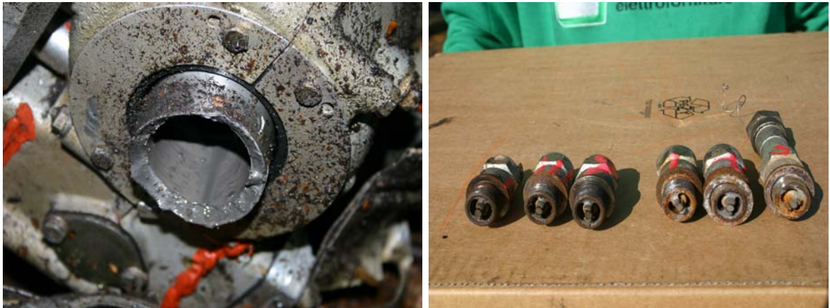
Foto 7: rottura albero motore e candele di accensione.
