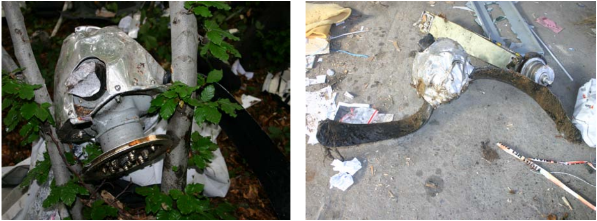
Foto 5: mozzo elica (rottura e deformazioni delle pale).
