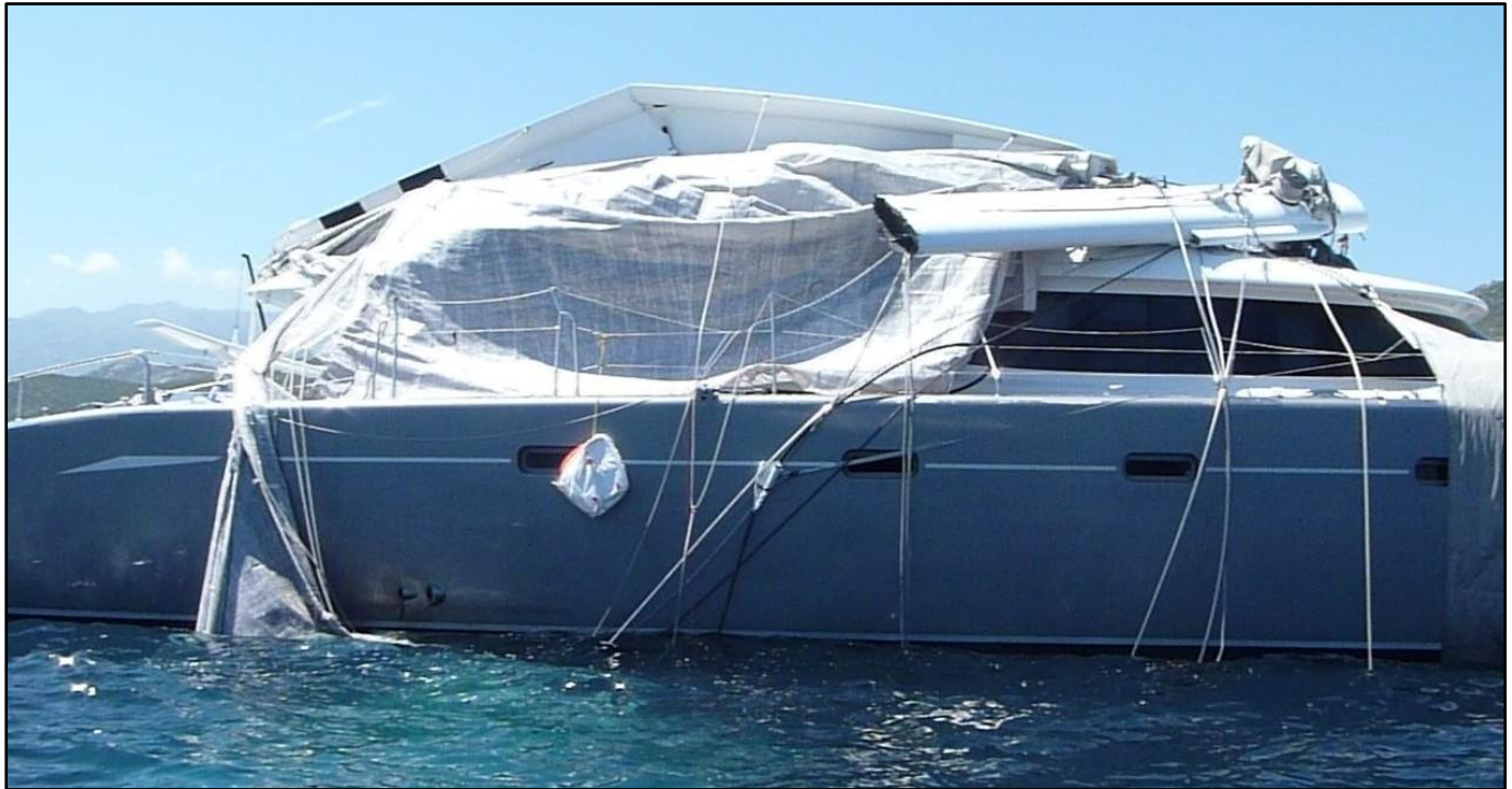
Cassure franche du 1 er tronçon
