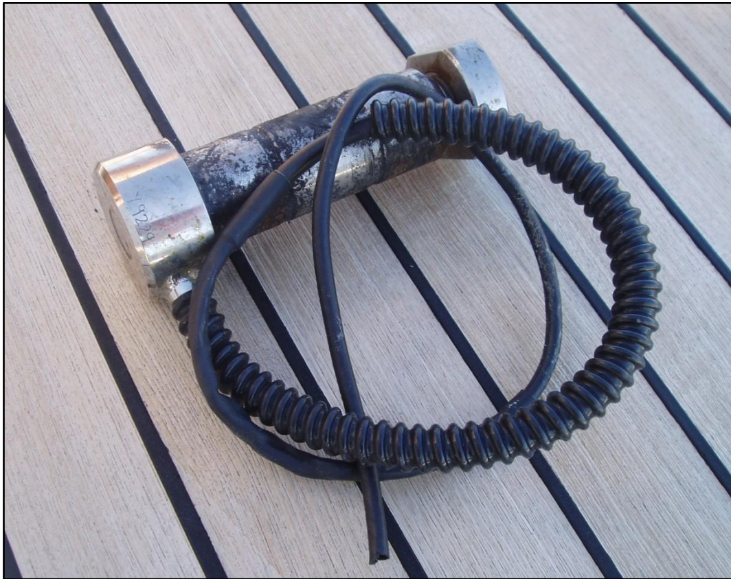
Jauge de contrainte d'un hauban
