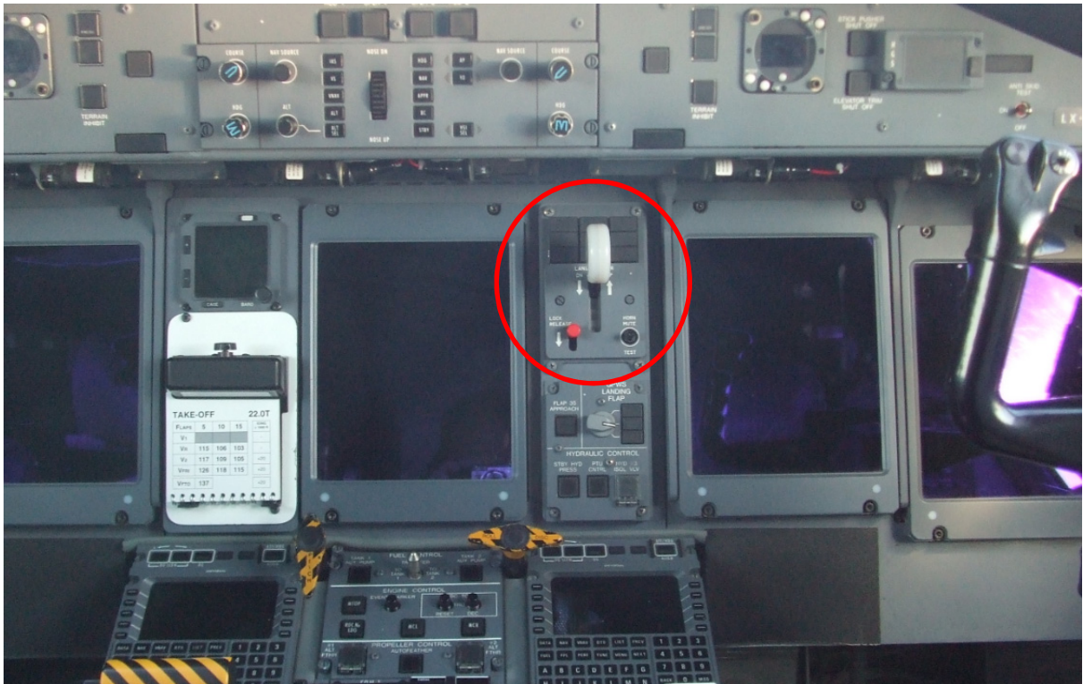
Position Fahrwerkshebel, Lock Release und Anzeigeleuchten im Cockpit
