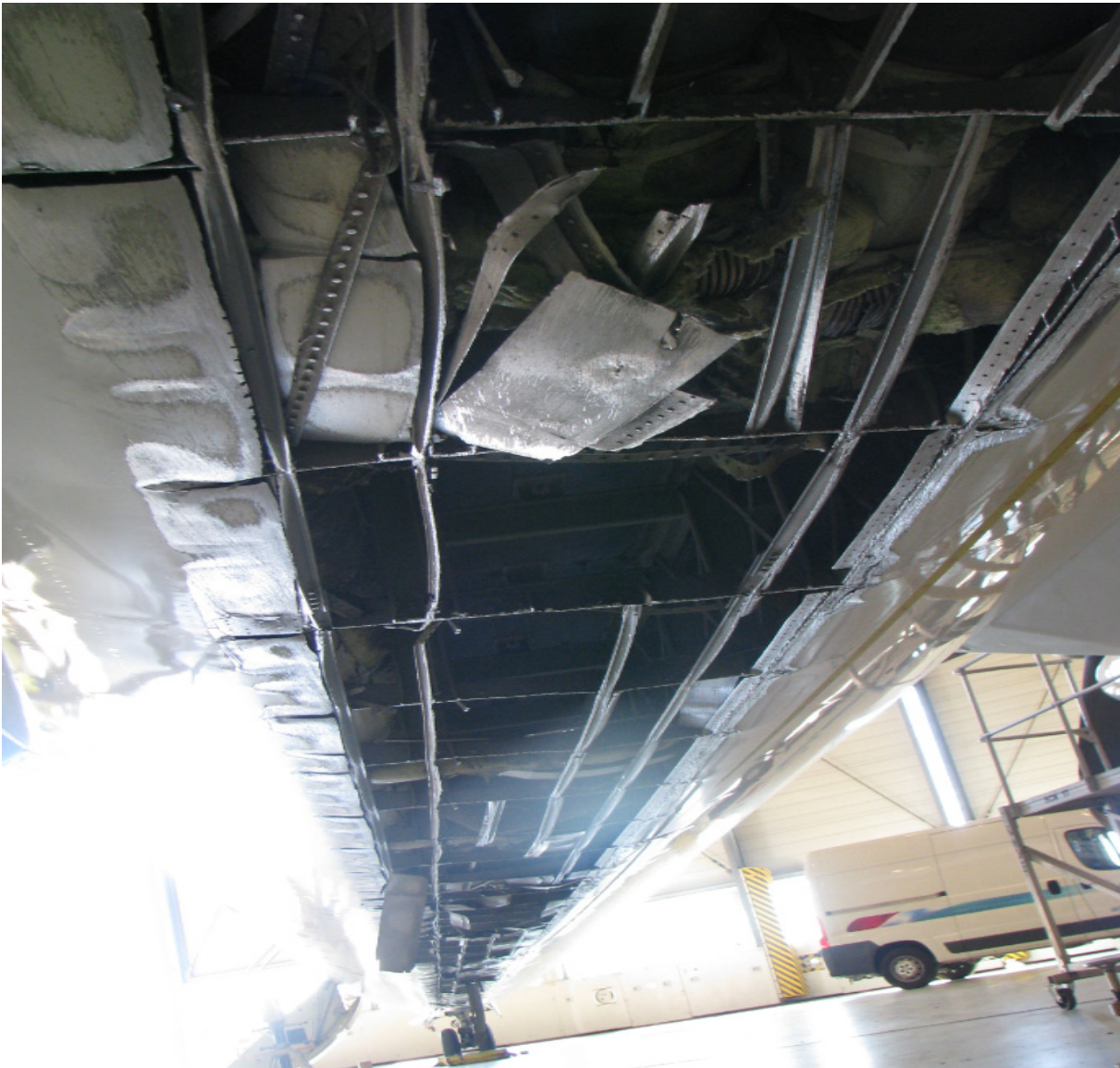
Schaden an der Unterseite des Rumpfes in Flugrichtung
