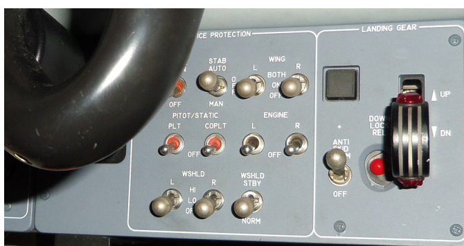
Figure 3 – Panneau de contrôle « ICE PROTECTION »
